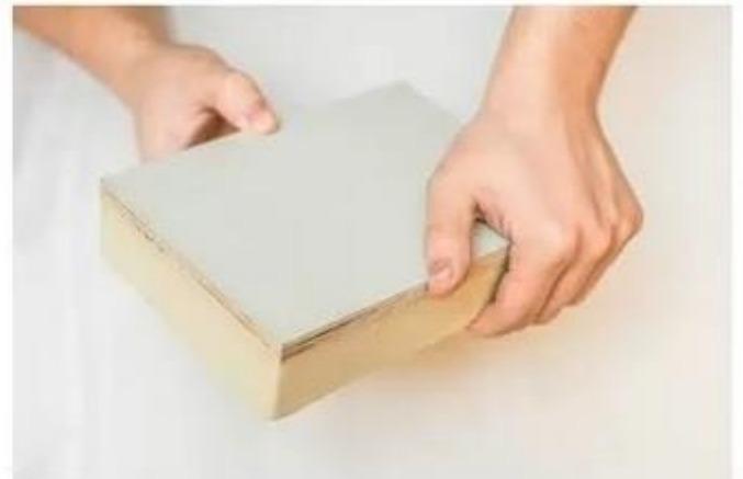
Образец слоя утеплителя ППУ с нанесенным поверх слоем из полимочевины
