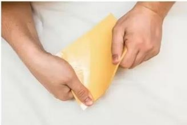
Образец гидроизоляционного слоя из полимочевины
